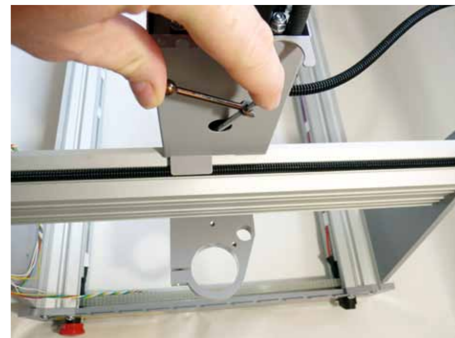
Zum Nachjustieren der Spieleinstellung an der Z-Achse ist ein langer 2,5-Millimeter-Kugelsechskant-Schraubendreher ideal
