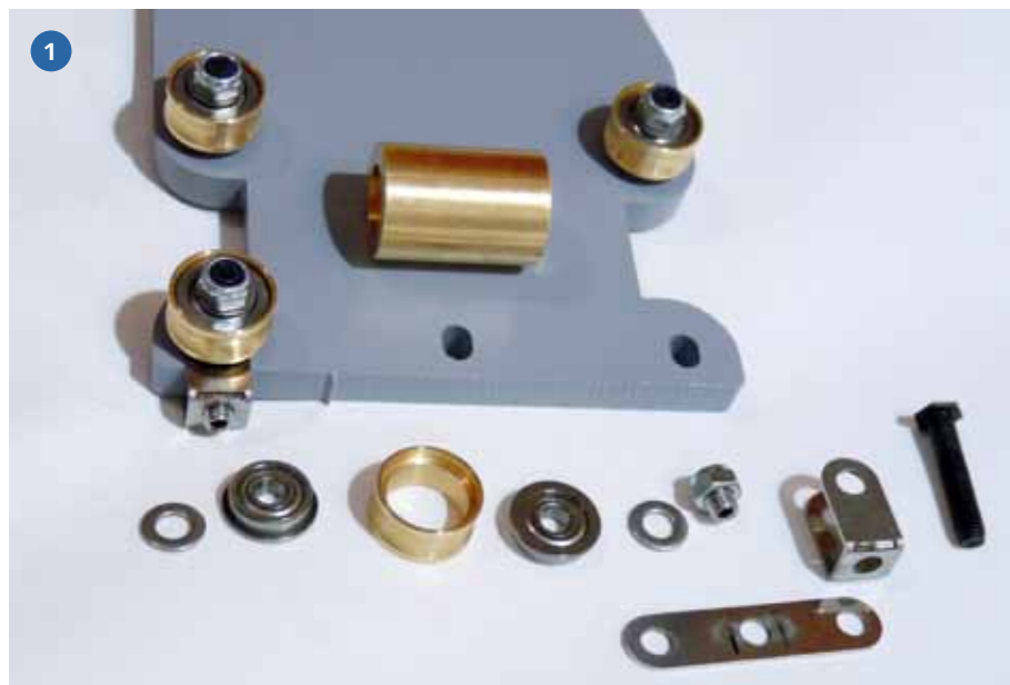
1) Die Montage der Achsen läuft an allen vier Stellen ähnlich ab und setzt die Anbringung von jeweils vier Laufrollen samt Spieleinstellungsmöglichkeit voraus. Hier sollten unbedingt die gezeigten Muttern mit Nyloneinsatz verwendet werden, da eine spätere Demontage bei locker werdenden Muttern sehr viel Zeit verschlingt. 2) Die Justierung der links zu erkennenden Innensechskantschrauben (in den Muttern) sorgt für eine stufenlose Einstellung des Spiels an den Achsen und sollte von Zeit zu Zeit kontrolliert werden. 3) Die für die Spieleinstellung zurechtzubiegenden Laschen sollten zunächst direkt hinter dem Ausschnitt mit einer Zange auf 90 Grad gebogen werden. Die zweite Seite kann anschließend per Hand direkt am späteren Einsatzort umgebogen werden.
