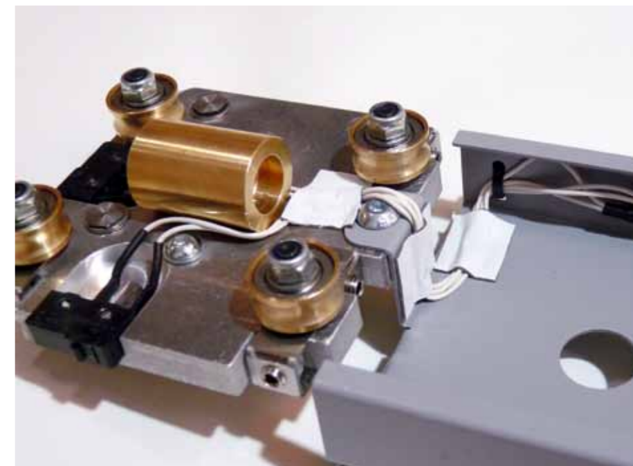
Entgegen der Anleitung kommt hier Doppelklebeband mit Gummizwischenschicht zum Einsatz, damit die Kabel nicht von den später zu montierenden Gewindespindeln beschädigt werden
