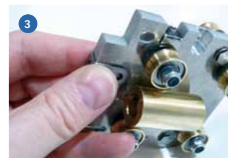
1) Die Montage der Achsen läuft an allen vier Stellen ähnlich ab und setzt die Anbringung von jeweils vier Laufrollen samt Spieleinstellungsmöglichkeit voraus. Hier sollten unbedingt die gezeigten Muttern mit Nyloneinsatz verwendet werden, da eine spätere Demontage bei locker werdenden Muttern sehr viel Zeit verschlingt. 2) Die Justierung der links zu erkennenden Innensechskantschrauben (in den Muttern) sorgt für eine stufenlose Einstellung des Spiels an den Achsen und sollte von Zeit zu Zeit kontrolliert werden. 3) Die für die Spieleinstellung zurechtzubiegenden Laschen sollten zunächst direkt hinter dem Ausschnitt mit einer Zange auf 90 Grad gebogen werden. Die zweite Seite kann anschließend per Hand direkt am späteren Einsatzort umgebogen werden.
