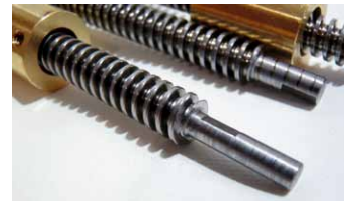
Die Gewindespindeln sollten vor dem Einbau sauber entgratet und anschließend im Seifenbad von jeglichen Metallspänen oder anderen Verunreinigungen befreit werden. Nur so ist später ein seidenweicher Lauf in den Messingbuchsen gewährleistet
