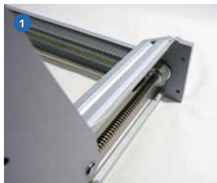
1) Die Kraftübertragung von einer Seite zur anderen geschieht über einen 10 Millimeter breiten Riemen vom Typ T5. Diese etwas gröbere Verzahnung setzt eine pingelige Justierung bei der Parallelität der beiden Seitenwangen zueinander voraus, um ein Verkanten zu vermeiden. 2) Der Durchgang ist an dieser Stelle arg eng, daher war ausnahmsweise etwas Material vom Alu-Distanzstück abzunehmen, um den Kabeln einen besseren Verlegeradius zu ermöglichen. 3) Die zunächst etwas verwirrende Verlegung der Kabel des Motors für die Z-Achse setzt vor allem Feingefühl bei der späteren Montage auf dem Profil der Z-Achse voraus, um kein Kabel einzuklemmen. Wichtig ist hier die Verwendung des längeren der beiden Verlängerungskabel, um die Steuerplatine auch sauber erreichen zu können
