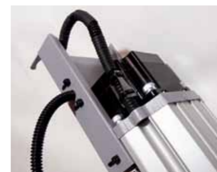
Als kleine Zugentlastung wurde das Motorkabel der Z-Achse noch etwas an der Seite fixiert
