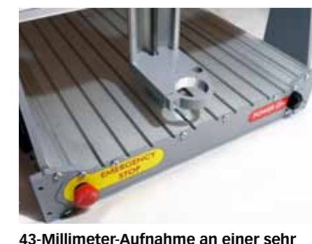
43-Millimeter-Aufnahme an einer sehr dicken Halteplatte. Jegliche Verkabelung ist auf die Rückseite verbannt und somit vor Spänen sowie Dreck sicher
