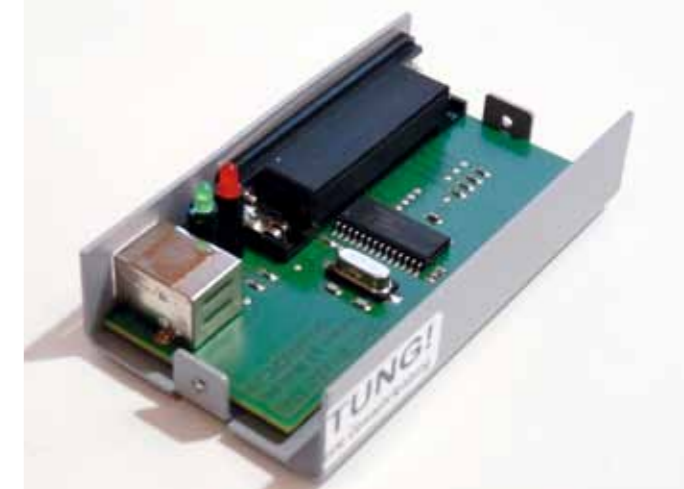
Die Wandlerbox beinhaltet einen quarzstabilisierten Taktgeber mit integriertem Speicher, um die Daten in Echtzeit und gepuffert an die Maschine geben zu können. Andernfalls würden sich unter Windows-Systemen schon nach etwa 30 bis 40 Minuten erste Schrittverluste einstellen
